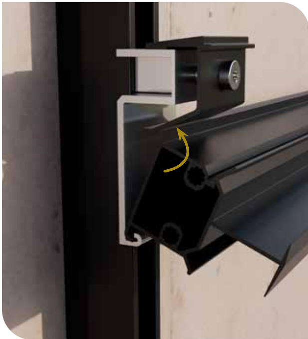
SCHRITT 5: Einlegeprofil im unteren Haken des Profilverbinders einhaken.
