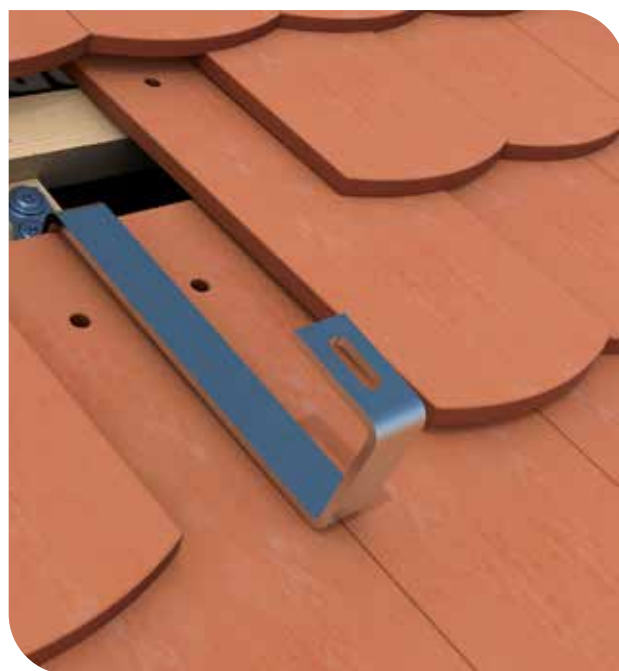
Dachhaken Biberschwanz an der Konterlatte montiert und mit Biberschwanzziegel eindecken.
