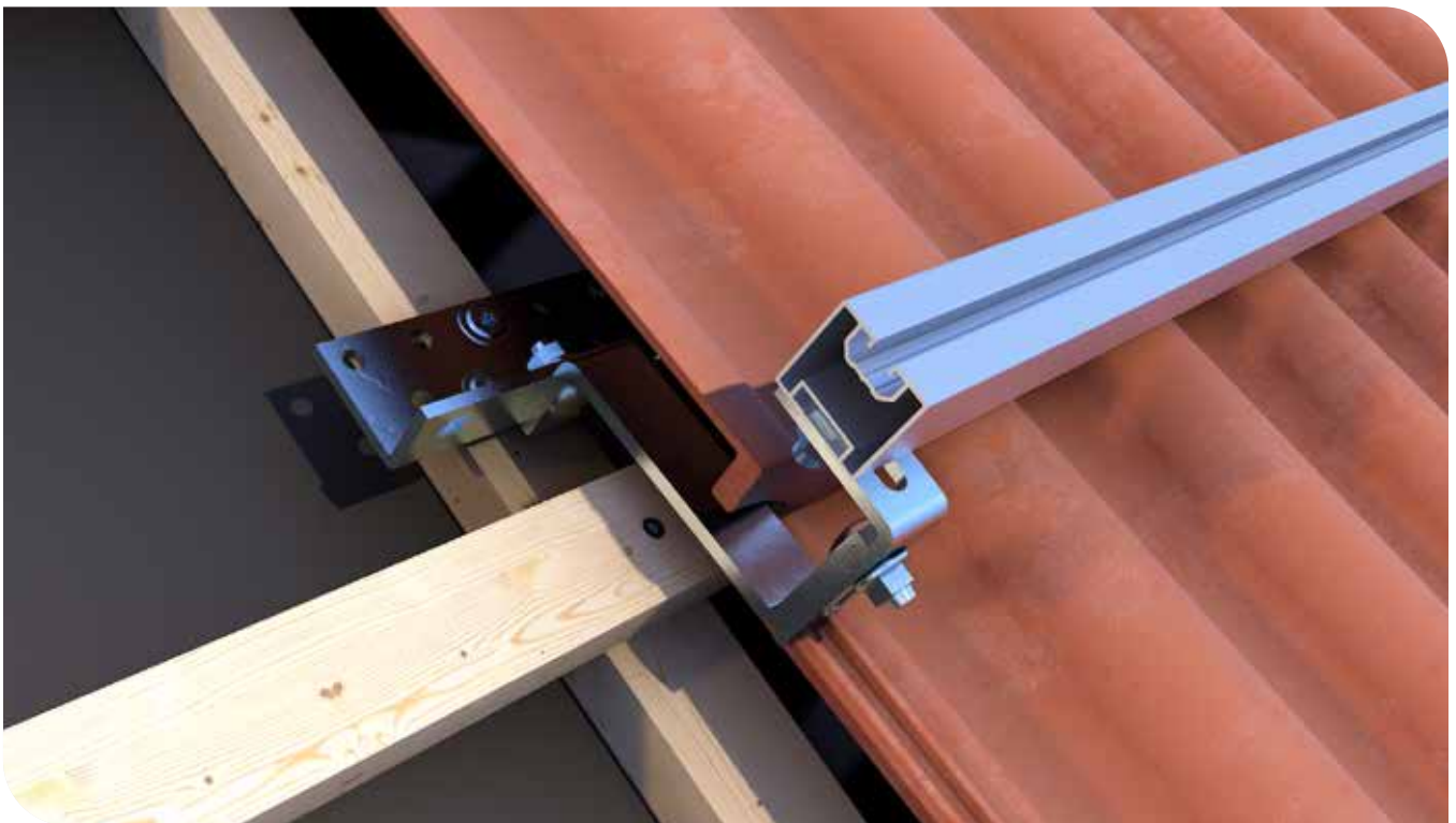
Der Dachhaken Flex wird an die Konterlatte montiert und schließlich mit dem bereits montierten Montageprofil am Dachhaken befestigt.
