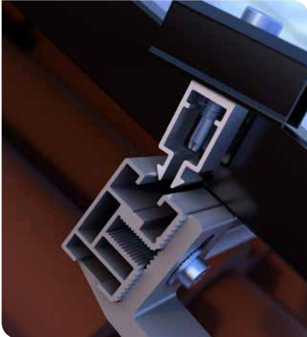
SCHRITT 1: Die Schraube der Klemme rausdrehen und den FASTFIX schräg in die Schiene einführen.
