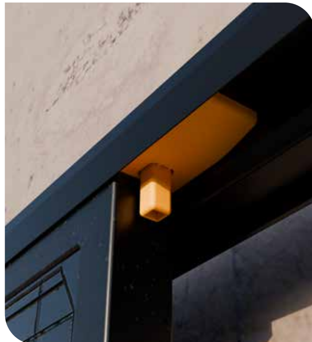
SCHRITT 11: Zwischen jedem Solarmodul wird in der oberen Einlegeschiene ein Abstandshalter LayTec eingesetzt. Dieser stellt automatisch einen Abstand von 10 mm zwischen den Solarmodulen her und verhindert ein Herausrutschen der Module nach oben. (Hinweis: Die orange Farbe dient lediglich der Darstellung; der Abstandshalter ist in der Ausführung schwarz.)
