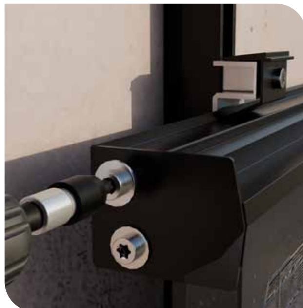
SCHRITT 13: Endkappen auf die offenen Enden der Einlegeprofile aufsetzen und mit den Fixierschrauben befestigen.
