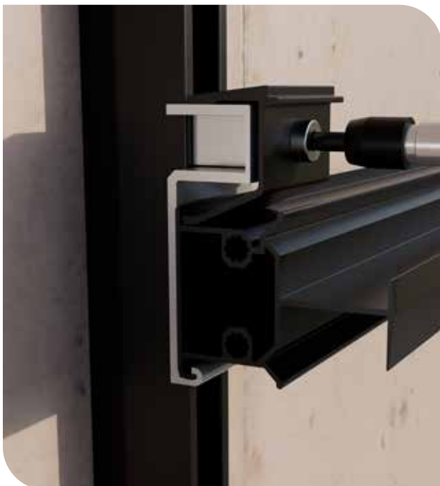
SCHRITT 7: Einlegeprofil ausrichten. Vertikaler Abstand zwischen den Einlegeprofilen: Modulhöhe plus 8 mm. Anschließend alles mithilfe der Schraube des Profilverbinders arretieren.
