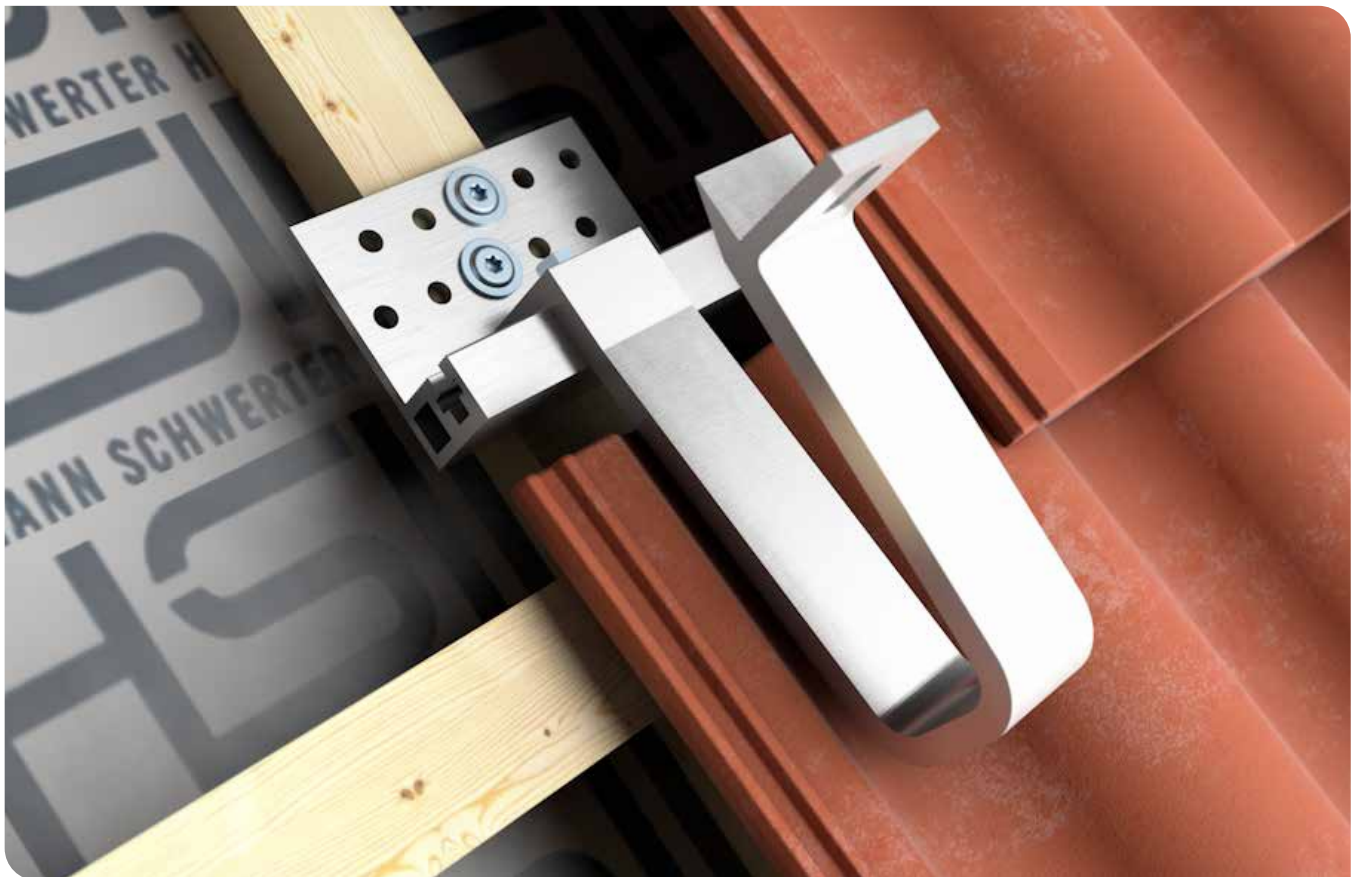
Der Dachhaken FIX-FIT V3 HEAVY wird an der Konterlatte montiert und mit dem bereits montierten Montageprofil FIX-FIT befestigt.
