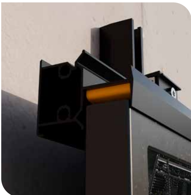
SCHRITT 12: Für Randbereiche den Stift am Abstandshalter an den vorgesehenen Sollbruchstellen abbrechen. Den vorbereiteten Abstandshalter anschließend, wie in Schritt 11 beschrieben, hinter das Modul klemmen. (Hinweis: Die orange Farbe dient lediglich der Darstellung; der Abstandshalter ist in der Ausführung schwarz.)
