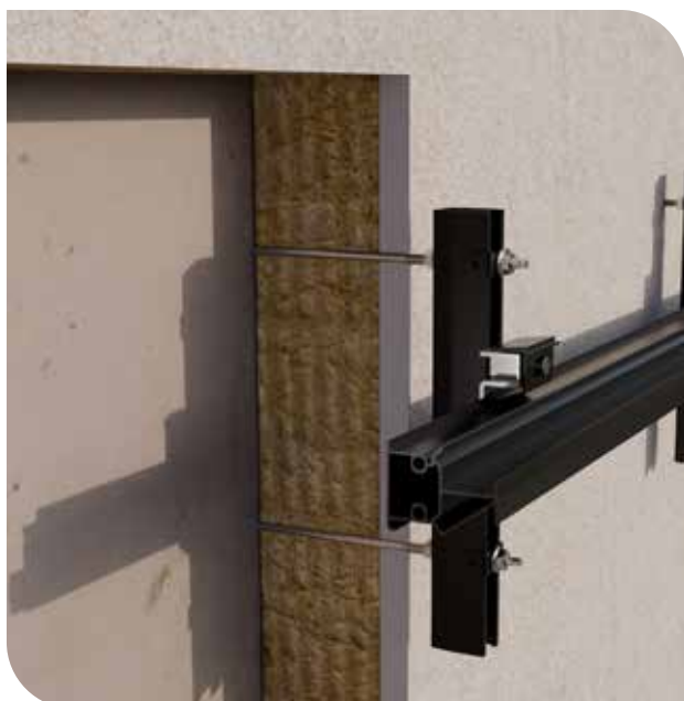
ALTERNATIVE ZU SCHRITT 3: Gewindestange M8, Edelstahl A2 in den Dübel einschrauben. Anschließend Sperrzahnmutter auf das M8 Gewinde aufschrauben. Basisprofil ausrichten und mit Hilfe von Fassadenbefestigung sowie Sperrzahnmutter arritieren.
