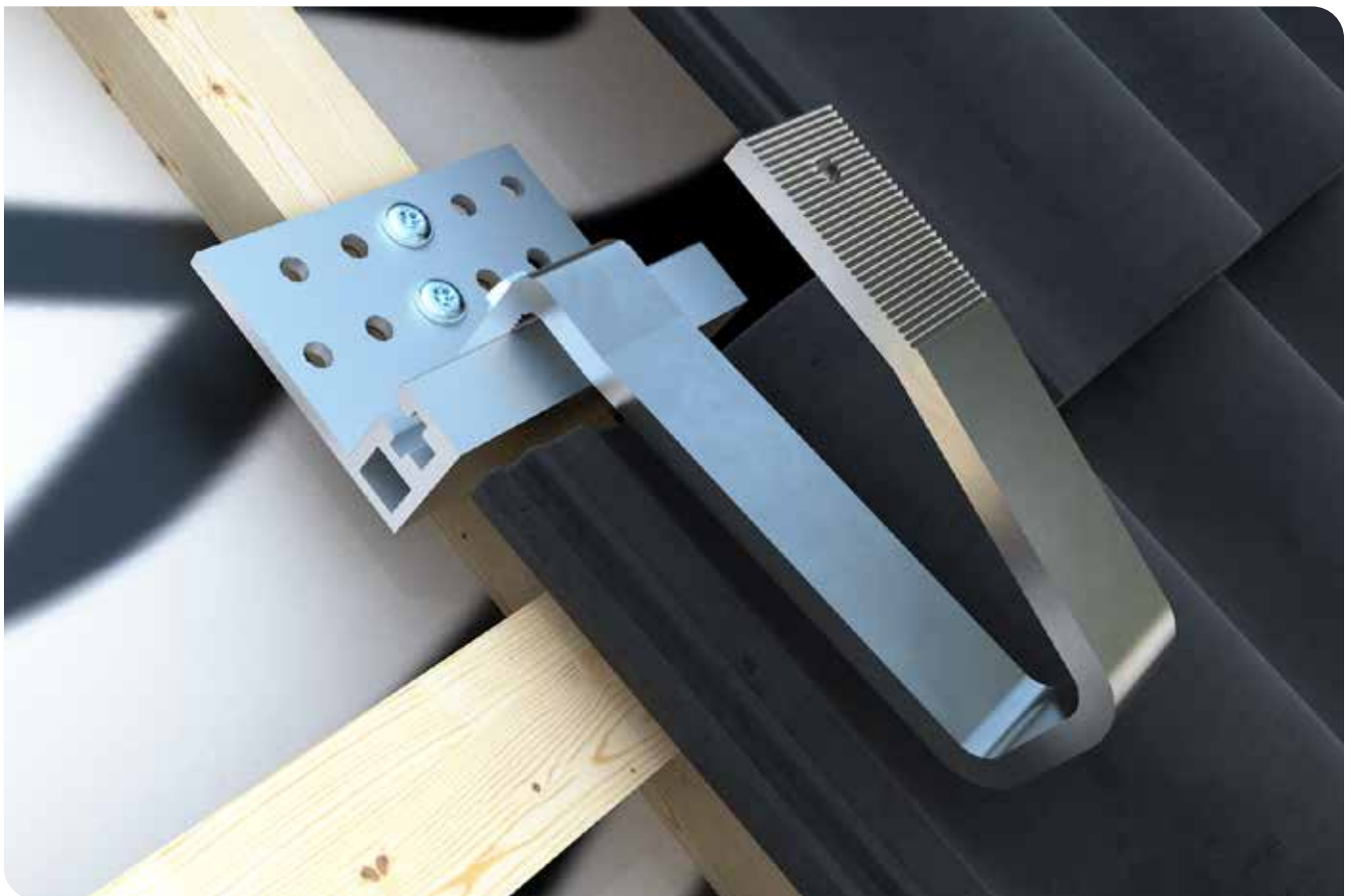
Der Dachhaken LayTec MAX wird an der Konterlatte montiert und durch die ausgeklinkte Dachpfanne geführt.
