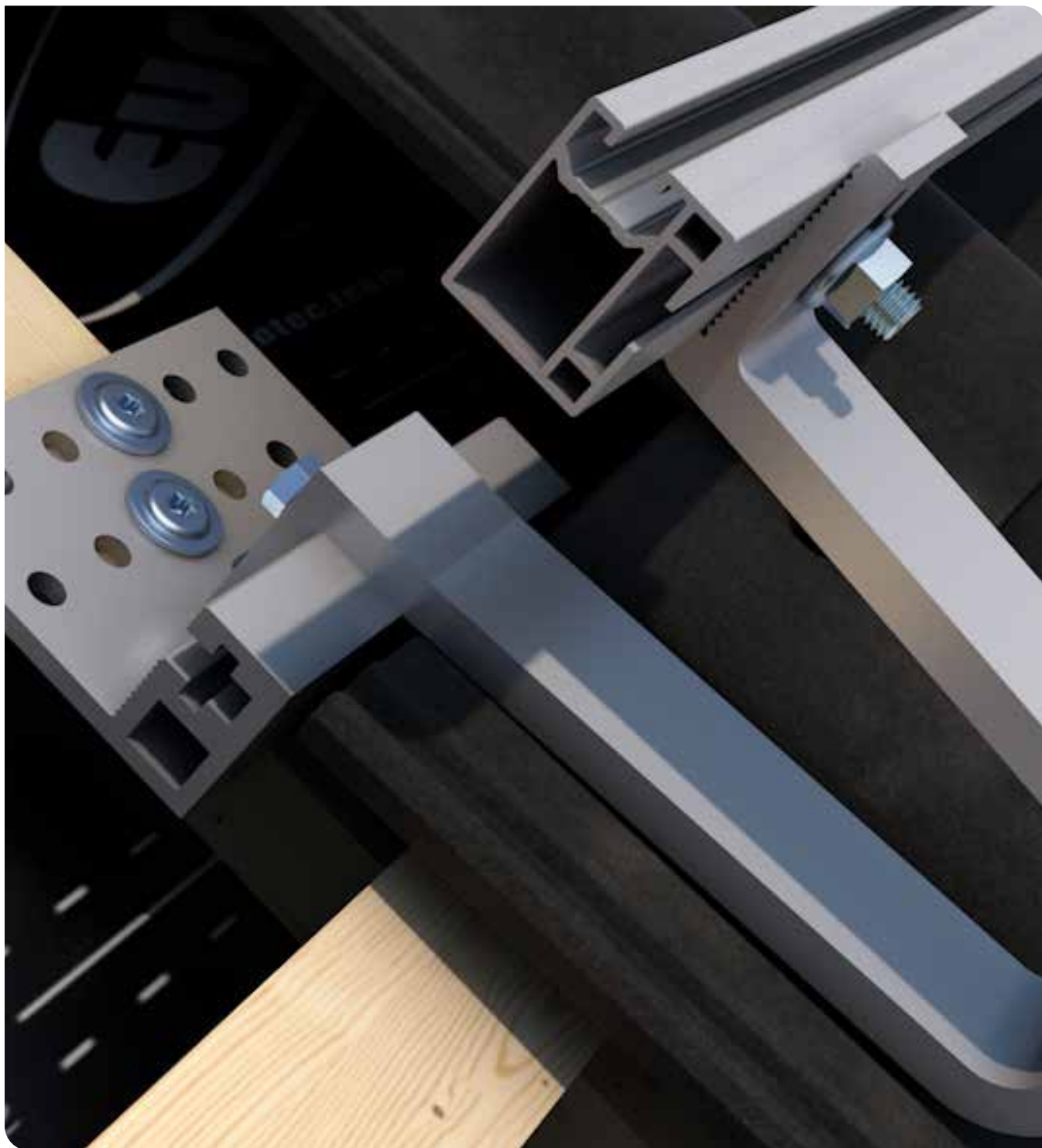
Montageprofil Steildach SLIM an Dachhaken FIX-FIT V3 VARIO mittels Hammerkopfschraube und Sperrzahnmutter befestigt.
